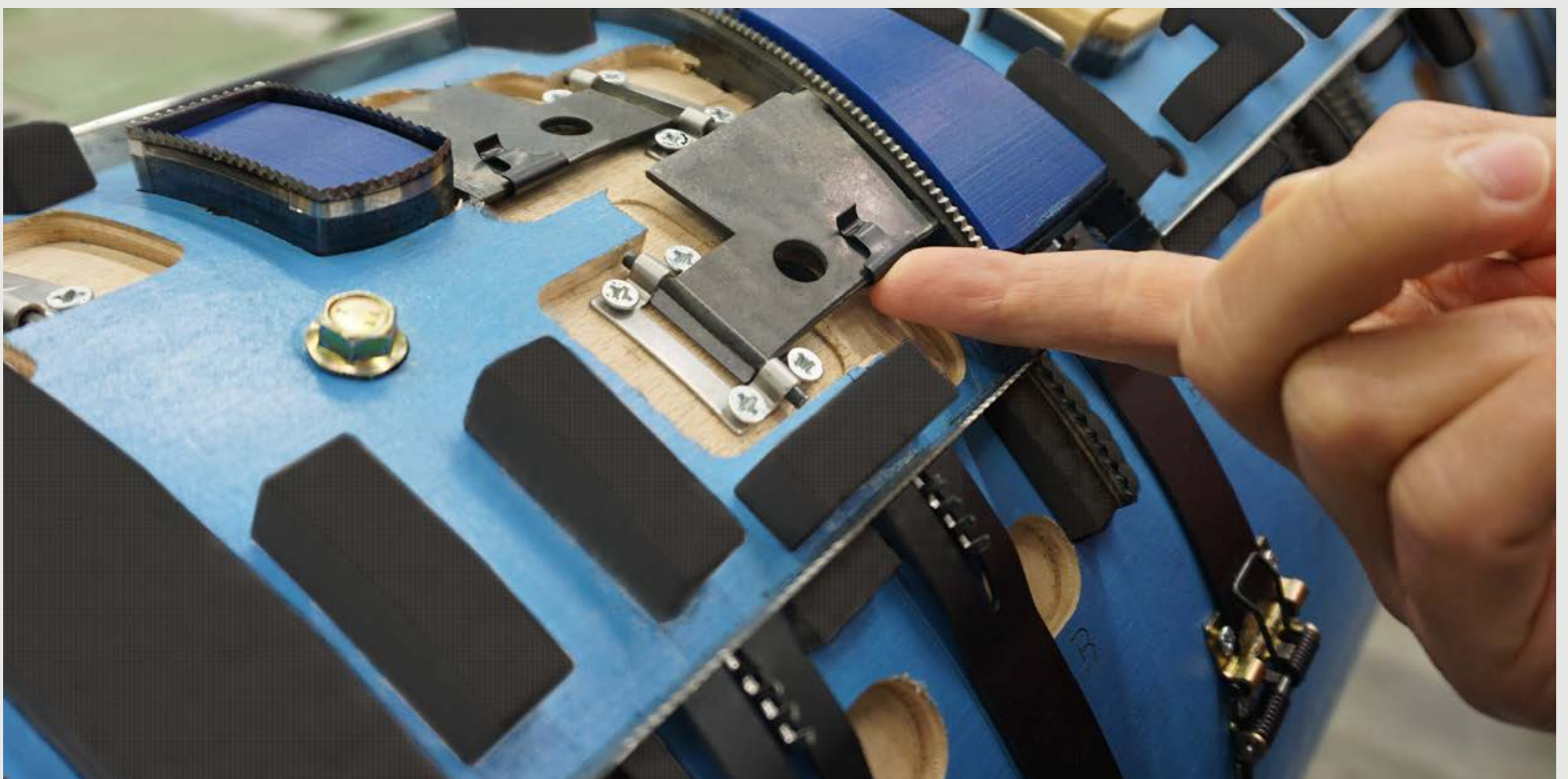
Rotationswerkzeuge mit aktiver Ausbrechtechnologie.
